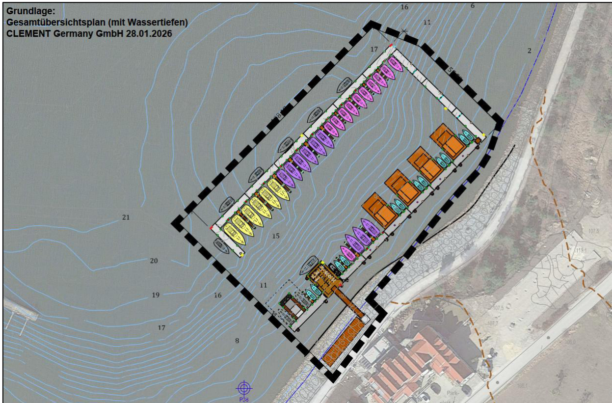
Abbildung 2: Übersichtsplan der Schwimmsteganlage mit Bootshäusern und Boot-Liegeplätzen (genordet) (Quelle: CLEMENT Germany GmbH über Planungsbüro Schubert)
